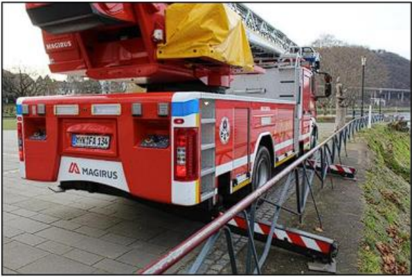
A korlát akadályozza a megtelepítést!
